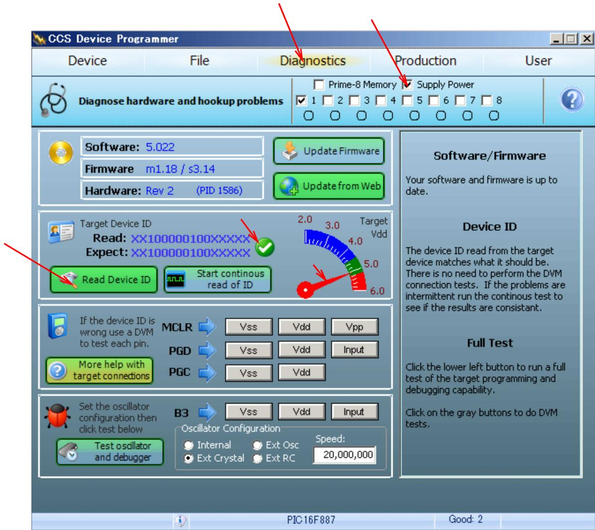
次に外部電源に切り替える場合は Device の Supply Power, Diagnostics の Supply Power のチェックを外す
