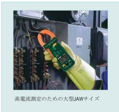
高電流測定のための大型JAWサイズ
