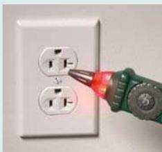
内蔵の非接触電圧検出器が電流線を自動的に検知し赤色LEDが点灯
