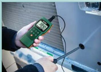
直径**18mm**ベーン・センタ付き伸縮式プローブが**1m**まで伸びますので容易に通気口に適合します。
