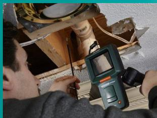
軽量のVideoScopeには最高の視野角を実現するために240°関節式先端を備えた6mm径のカメラと有線ハンドセットが含まれています。関節式カメラチップの簡単な片手操作は標準的なカメラチップがアクセスできない障害領域での観察を容易にします。画像や動画は高解像度の大型カラーディスプレイや外部モニターで見ることができ、SDメモリーカード(付属)やUSBフラッシュ・ドライブに保存できます。
