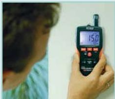
比侵襲測定で壁の水分を測定
