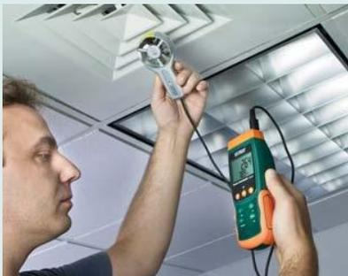
空調設備で風速と温度を測定
