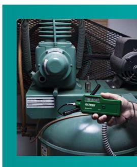
便利なコンパクト・サイズの振動計は産業用機械の振動レベルを測定します。ミスアライメント、乏しいバランス、構造的な妥協、およびその他の要因は不要な振動増加を引き起こす可能性があります。VB450は広帯域10Hz~1500Hzの周波数範囲が特徴で変位、速度、加速度の測定を提供します。アプリケーション: 一貫生産性と作業者の安全のための適切な設置/保守を確実にするために
