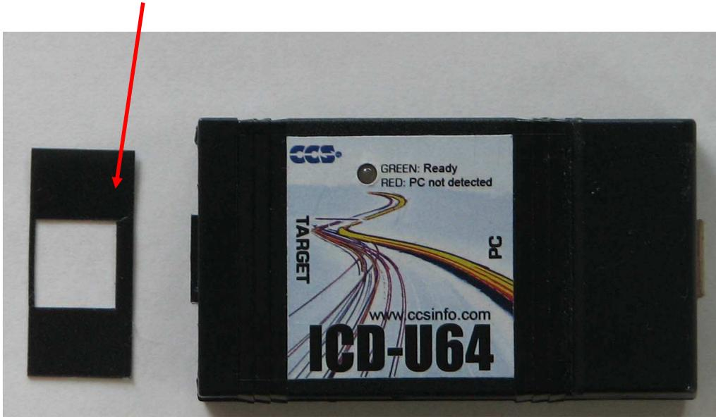
2. 上下のフタを横の隙間2カ所にマイナスドライバを当ててこじ開けるようにします。この時内部の爪を割らないよう注意して下さい。上下で4カ所あります。
